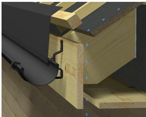
Tuuletõkke paigaldus katusekonstruktsioonis, avatud tuulekastiga lahendus
